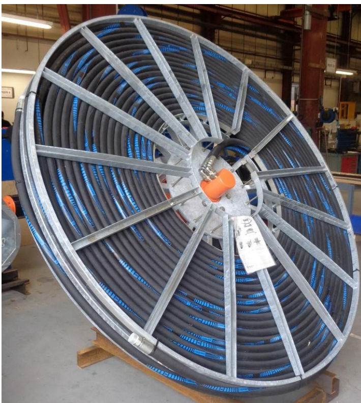
BU: Schlauchtrommel mit Drehübertrager mit 2 x 1" Anschluss für die Zuführung von Argon-Gas mit zwei Schläuchen
