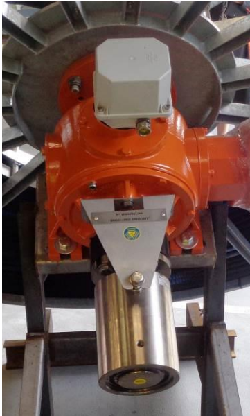
BU: Drehübertrager mit 2 x 1" Anschluss für die Zuführung von Argon-Gas mit zwei Schläuchen
