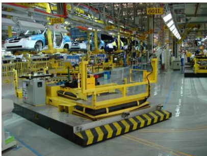
Fahrerlose Transportfahrzeuge (AGV) in der Hochzeit, der Zusammenführung von Fahrwerk und Karosserie, bei GM in China, versorgt mit einem IPT® Floor System.
