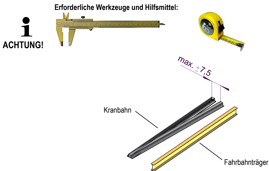
Abb. 8: Horizontaler Versatz der Kranbahn zum Fahrbahnträger
