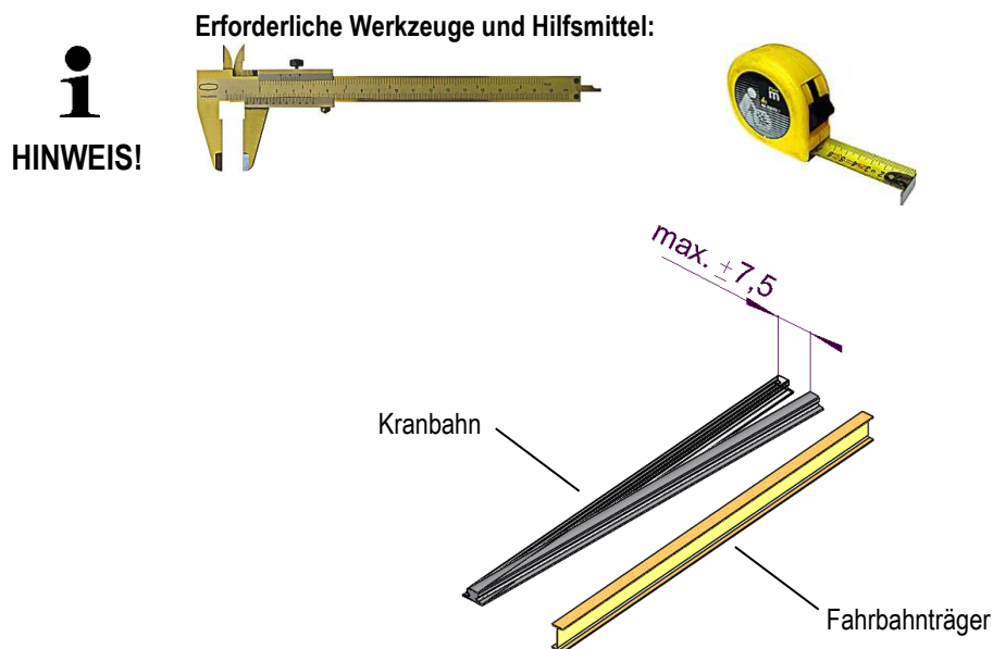
Abb. 8: Horizontaler Versatz der Kranbahn zum Fahrbahnträger
