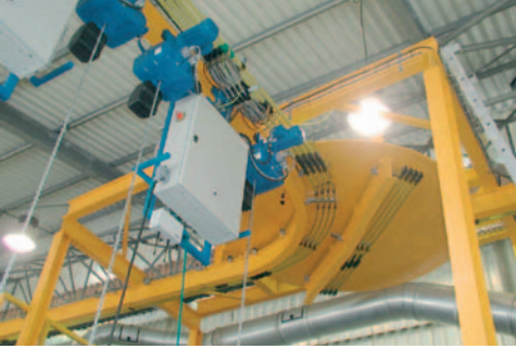
SinglePowerLine 0812 v galvanově, přejezdové elementy na otočné vyhybce a dvojité sběrače proudu
