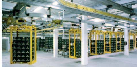
SingleFlexLine 0811 na elektrické podvěsné dráze v pivovaru
