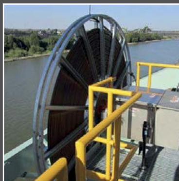
Приводной кабельный барабан на корабельном загрузчике США
