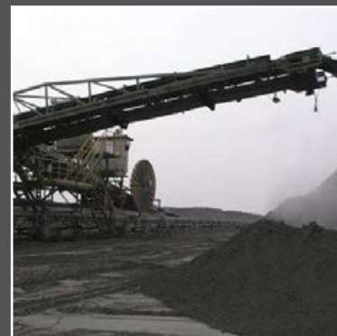
Приводной кабельный барабан на Стакере, Чехия
