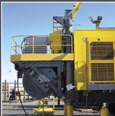
Приводной кабельный барабан на буровом станке, США
