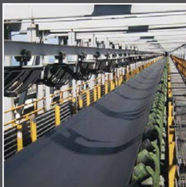
Подвесная система на конвейере со сбрасывателем, Венесуэла
