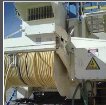
Приводной кабельный барабан на буровом станке, Чили
