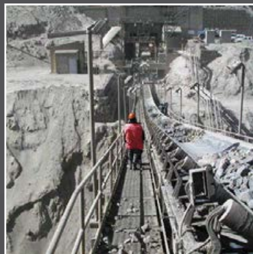
Подвесная система на конвейере, Чили
