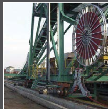
Приводной кабельный барабан На Стакере/Реклеймере, Тайланд
