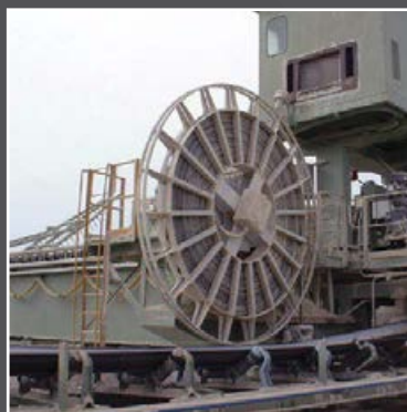
Барабан рядной намотки на стакере-реклемере, США
