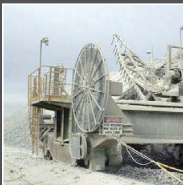
Приводной барабан на стакере-реклемере, США
