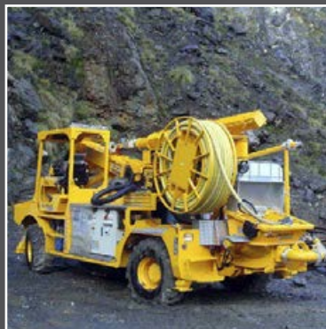
Приводной шланговый барабан на машине для торкретирования, Испания
