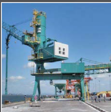
Приводной кабельный барабан на корабельном разгрузчике, Корея
