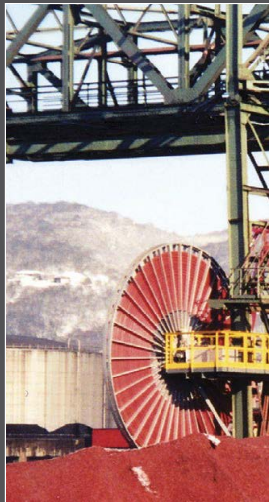
Приводной кабельный барабан на судовом разгрузчике, Германия
