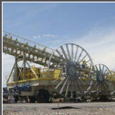
Приводные кабельные барабаны на радиальном стакере, Великобритания
